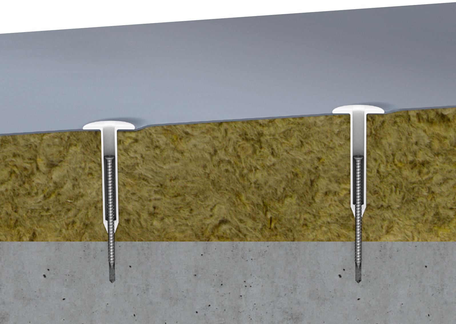
Flachdächer haben in der Regel ein Mindestgefälle von 2 %, damit Regenwasser gezielt ablaufen kann. Bei einer Gefälledämmung musste der Monteur zur Befestigung der Dichtungsbahn bisher für jede Gesamtaufbauhöhe einen entsprechend langen Befestiger verwenden. Einfacher und wirtschaftlicher sind Flachdachbefestiger, die in der Höhe justierbar sind wie beispielsweise der JBS-R/EcoTek für Betonuntergründe.
