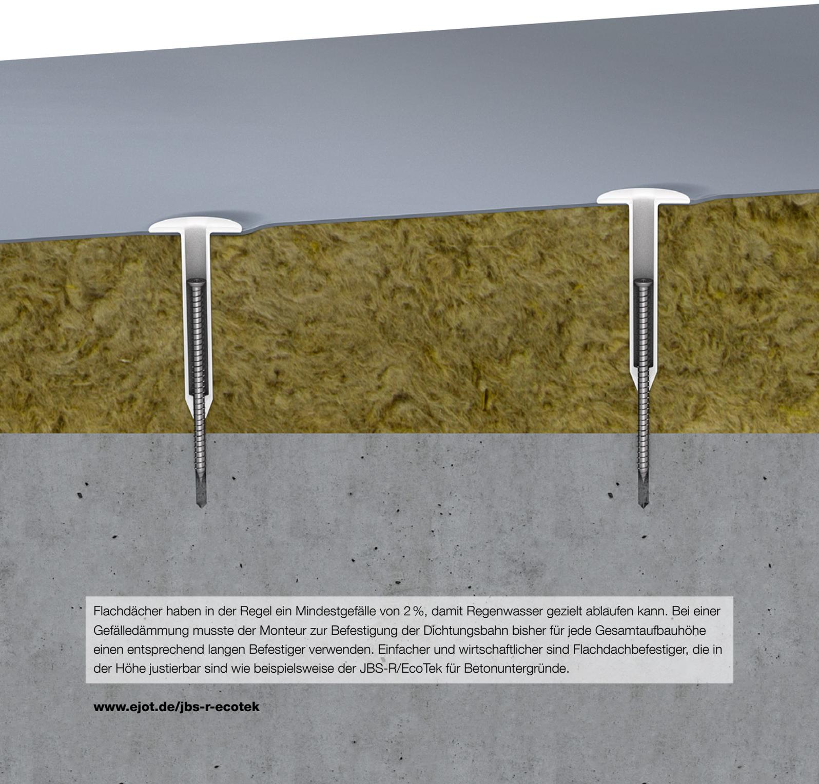
Flachdächer haben in der Regel ein Mindestgefälle von 2 %, damit Regenwasser gezielt ablaufen kann. Bei einer Gefälledämmung musste der Monteur zur Befestigung der Dichtungsbahn bisher für jede Gesamtaufbauhöhe einen entsprechend langen Befestiger verwenden. Einfacher und wirtschaftlicher sind Flachdachbefestiger, die in der Höhe justierbar sind wie beispielsweise der JBS-R/EcoTek für Betonuntergründe.
