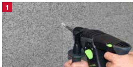
Schnelle Bohrlocherstellung dank geringer Bohrtiefe
