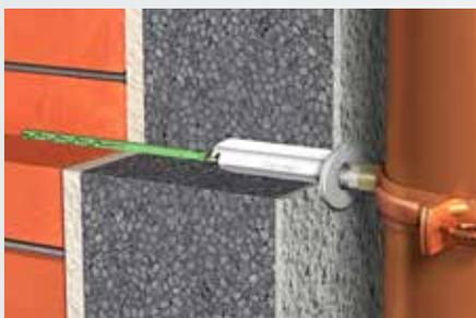
Befestigung durch Aufnahme handelsüblicher Grobwindeschrauben Ø 9 mm bzw. Stockschrauben Ø 9 mm mit Ansatzgewinde M10.
